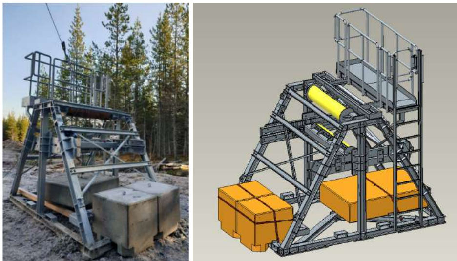
Abbildung 39 Darstellung eines Gestells für die Reibseilabspannung
